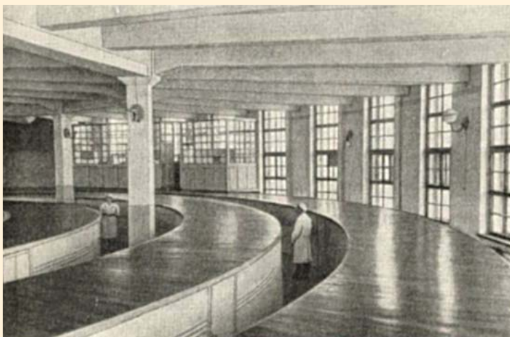
Закрытый конвейер хлебозавода
